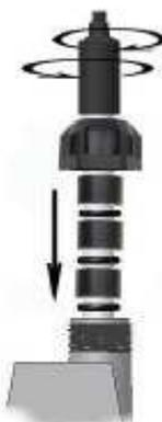
**Attention** ne jamais exécuter des flexions de l'électrode sous peine de destruction immédiate de l'électrode. A l'intérieur de l'électrode il y a une pipette de verre très fragile.
